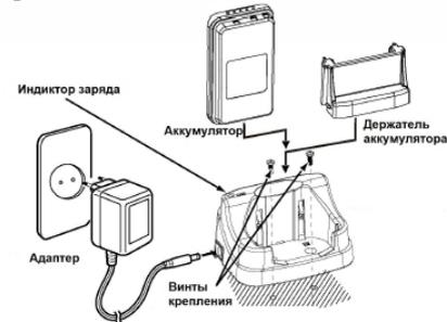
**Примечание:** Вы можете закрепить настольное зарядное устройство на столе с помощью саморезов.
